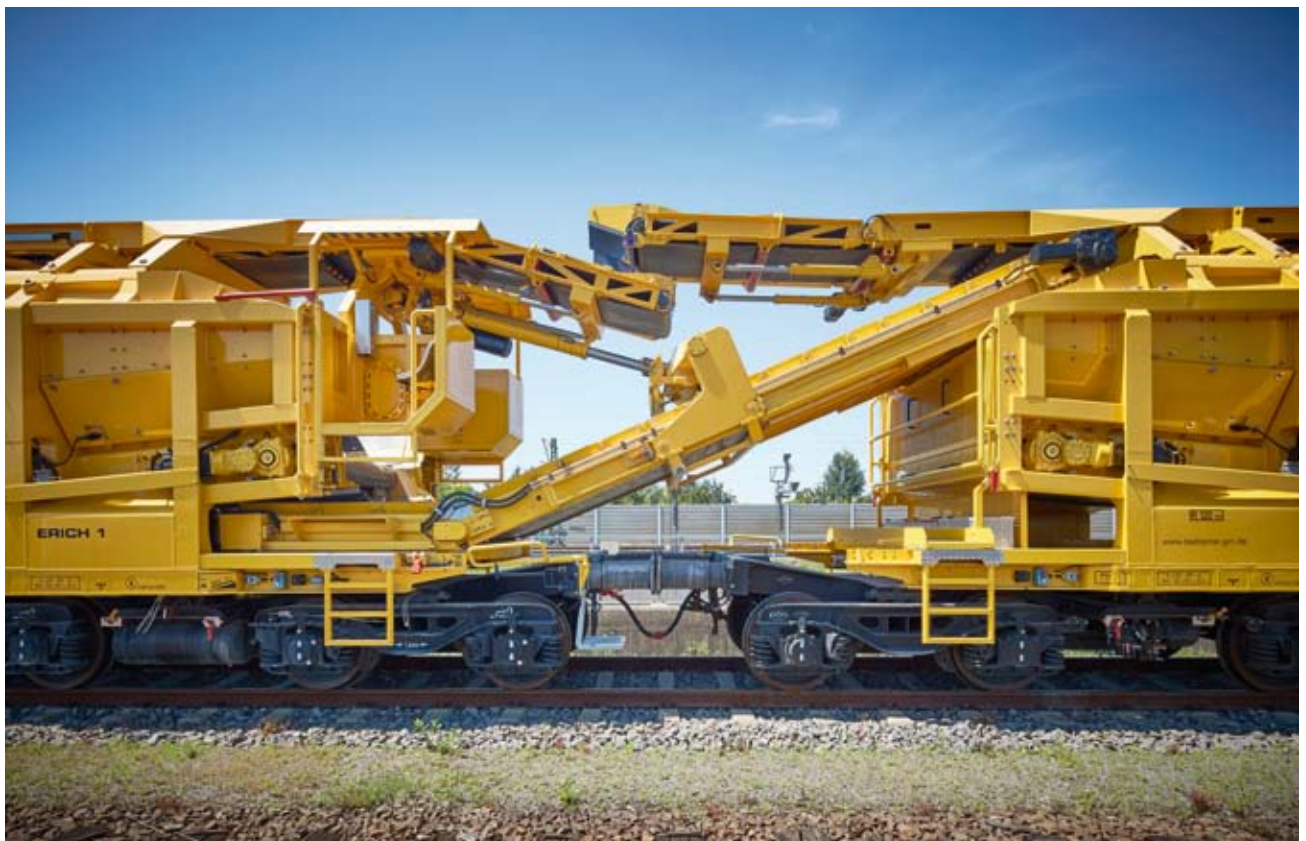
An- und Abtransport gleichzeitig: Die kombinierte Be- und Entladestation funktioniert ohne Pause in beiden Richtungen. Das Material wird dabei über zwei Ebenen hin- und zurückgeführt.
